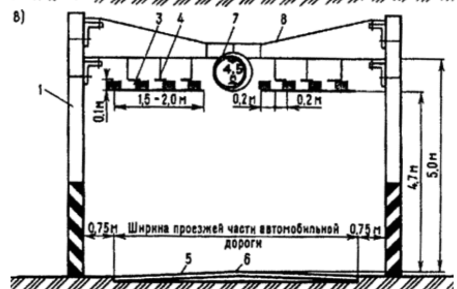
а – с плоской металлической фермой; б – деревянные; в – с металлическими растяжками; 1 – опоры; 2 – металлическая ферма; 3 – ограничительные планки; 4 – металлическая цепь или проволочные подвески; 5 – проезжая часть автодороги; 6 – сплошная осевая линия; 7 – дорожный знак 3.13 «Ограждение высоты»; 8 – металлические растяжки
